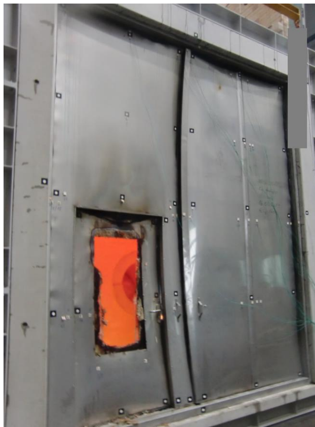
Abb. 2: Versuchstor nach 158 min
